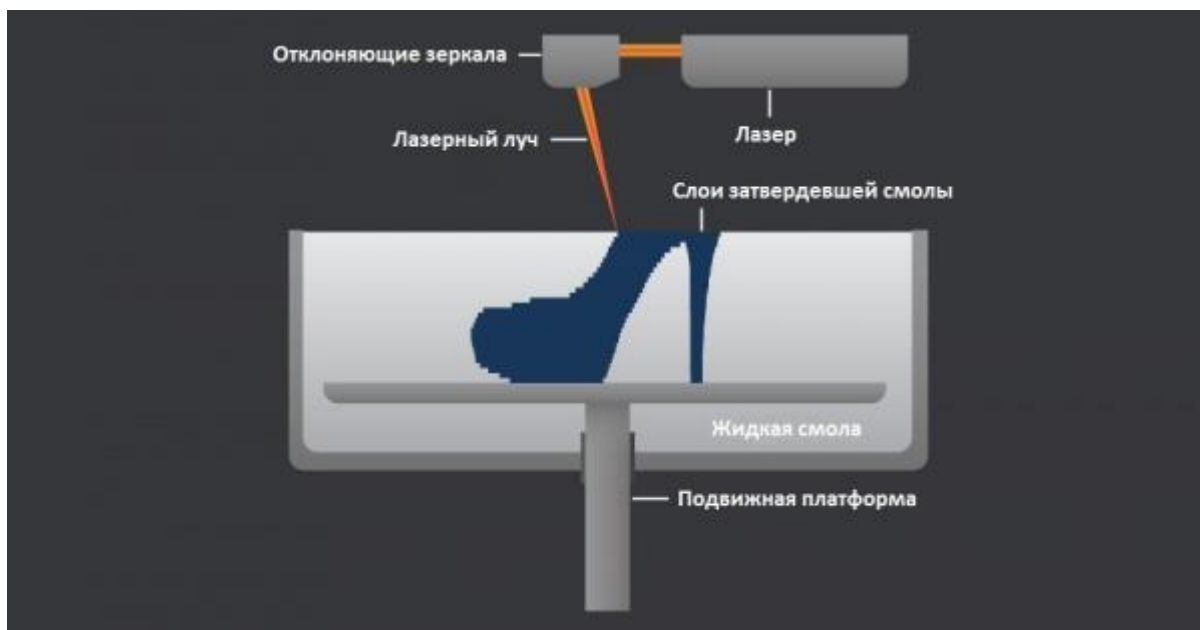
2.4 сурет – SLA принтердің жұмыс схемасы
